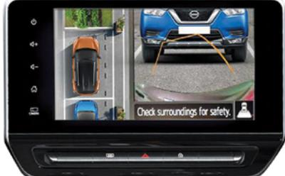
Vue arrière avec lignes de guidage pour le stationnement
